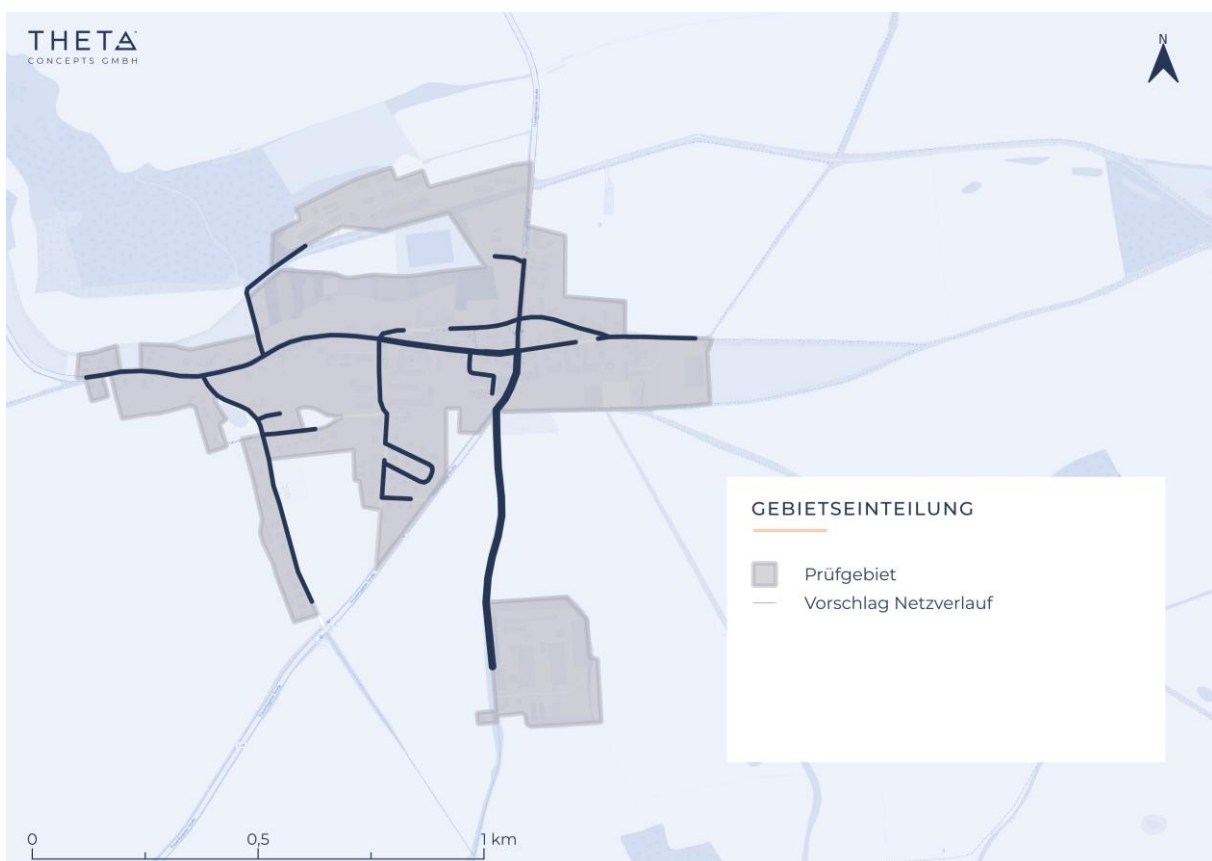
Abbildung 7-8: Mögliches Wärmenetz Schönermark
